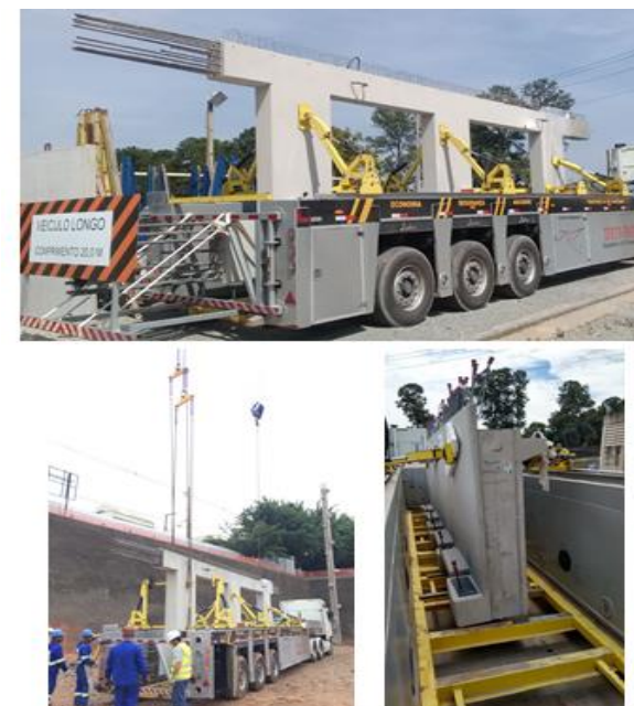
Figuras 83, 84 e 85: Utilização de carretas inloader (sem eixos transversais), para transporte de peças com altura superior à 3m.
